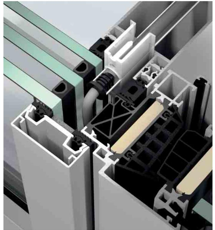
Schüco Fassade FWS 50.SI mit neuer passivhauszertifizierter Isolatortechnologie
